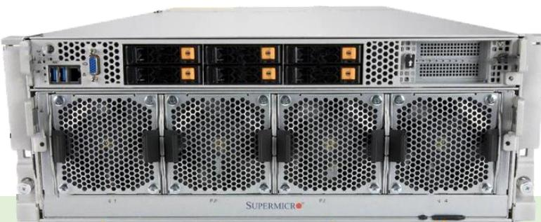
JY428K 机架式服务器为加速计算而构建，针对 CPU 和 GPU 异构计算特点，支持双路 AMD EPYC™ 7003/7002 系列处理器，支持 NVIDIA HGX A100 8-GPU；通过 NVIDIA NVLINK 可以实现 GPU 高速计算低延迟的数据通信，支持现有数据中心基础设施标准，在现有基础上加速深度学习和 HPC 应用，为用户带来卓越性能体验。借助 JY428K 服务器，可以满足 AI/深度学习、HPC、云游戏、分子动力学
