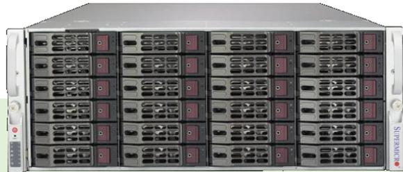
JY440T 是搭载新一代英特尔志强系列可扩展处理器的四路机架式服务器，为满足对空间部署和高性能计算要求设计，能够在标准 4u 空间承载双倍运算性能，大幅度提高算力，可广泛应用于高性能计算、互联网、虚拟化、云计算、IDC 等场景。JY440T 具有高密度、高可靠、高性能、易管理、易部署等优点。
